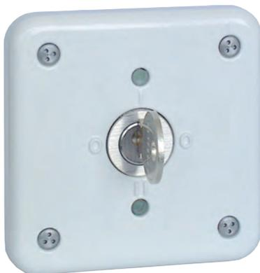
Schlüsselschalter mit optischer Anzeige der jeweils aktiven Schließstellung in robuster Ausführung zur Montage im Zellenflur zur Anwesenheitsmarkierung, Rufabstellung, Vorbereitung des Beamtenalarms (Stellung 1), Vorbereitung des Beamtenalarms bei Zeitüberschreitung (2) und zur Zwangseinschaltung der Haftraumbeleuchtung (1 und 2), bestehend aus
