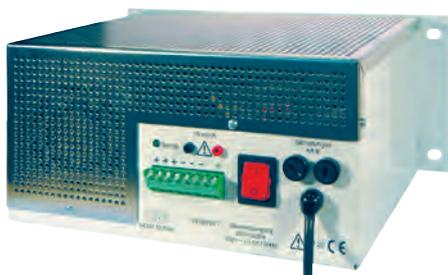
Netzgerät zur stationsweisen Spannungsversorgung, vorbereitet für Wandmontage oder waagerechte Aufstellung, geeignet für besonders hohe Einschaltströme, Ausführung gemäß EN60601-1, 2 MOPP, Schutzklasse I, IP20, spannungsstabilisiert und kurzschlußfest, mit internem Lüfter, Lieferung einschließlich Netzanschlußkabel.
