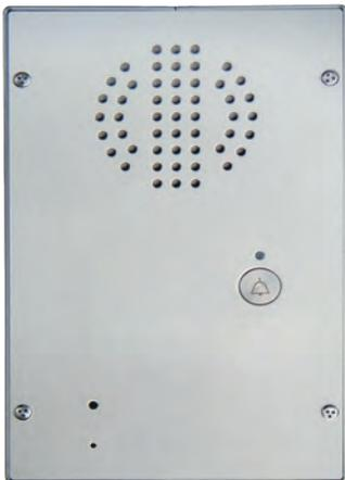
Die Geräte der Typenreihe ZF ergänzen als abgesetztes Bedien- und Sprechteil die verdeckt und geschützt installierte Zellenelektronik ZET-U zu einem vollwertigen Zellenterminal. Die Größe der Frontplatte entspricht der Geräteserie ZET, es findet der gleiche Putzkasten Verwendung. Es wird kein separater Leitungsverteiler benötigt, die Kabel werden direkt über abziehbare Stecker angeschlossen.
