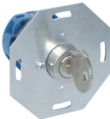
Schlüsselschalter für projektbezogene Flächenprogramme zur Montage im Zellenflur, bestehend aus dem Schlüsselschaltereinsatz Fabrikat KABA, 2-polig mit projektbezogener Schließung mit den Schaltstellungen I-O-II, sowie einer Montageplatte, 1 Schlüssel, Schlüsselabzug in jeder Stellung, geeignet für Einbaudosen SSD (JV009030).
