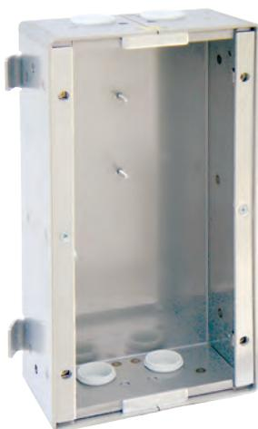
Stahlblecheinbaukasten für die Zellenterminal der Baureihe ZSP, gefertigt in Unterputz-Ausführung aus V2A-Stahl und breitem Stahlrahmen für wandbündigen Einbau und vorbereiteter Aufnahme für Kabeldurchlässe auf allen Seiten, Anschluß für Schutzterde, Putzdeckel. Der Kasten wird nach dem Einbau mit dem Montagesatz MS-ZLT (JV004007) ausgerüstet.
