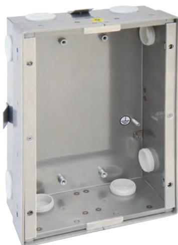
Stahlblecheinbaukasten für die Zellenterminal der Baureihe ZF, gefertigt in Unterputz-Ausführung aus V2A-Stahl und breitem Stahlrahmen für wandbündigen Einbau und vorbereiteter Aufnahme für Kabeldurchlässe auf allen Seiten, Anschluß für Schutzterde, Putzdeckel. Der Kasten wird nach dem Einbau mit dem Montagesatz MS-ZLT (JV004007) ausgerüstet und ist vorbereitet zur Aufnahme des Zellenverteilers VZET (JV004010).
