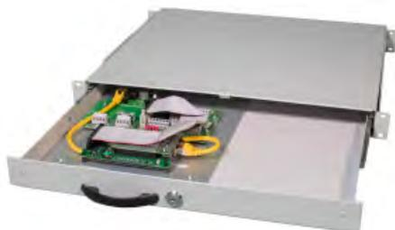
IP-Modul als universelle Schnittstelle zum Einbinden konventioneller Zusatzgeräte sowie zur Datenübergabe an bzw. Datenübernahme von Fremdgeräten über eine serielle RS485-Schnittstelle.
