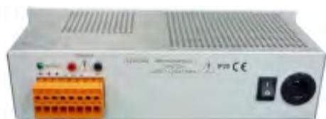
Netzgerät für stationsweise Spannungsversorgung für kleinere und mittelgroße Anlagen, geeignet für hohe Einschaltströme, vorbereitet für Wand- oder Hutschienenmontage, Ausführung entsprechend EN60601-1, spannungsstabilisiert und kurzschlußfest, interner Klemmblock für Netzanschluß.
