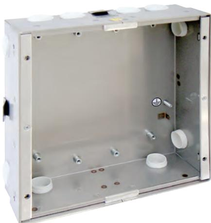
Stahlblecheinbaukasten für die Zellenterminal der Baureihe ZEU, gefertigt in Unterputz-Ausführung aus V2A-Stahl und breitem Stahlrahmen für wandbündigen Einbau und vorbereiteter Aufnahme für Kabeldurchlässe auf allen Seiten, Anschluß für Schutzterde, Putzdeckel. Der Kasten wird nach dem Einbau mit dem Montagesatz MS-ZLT (JV004007) ausgerüstet und ist vorbereitet zur Aufnahme des Zellenverteilers VZET (JV004010).
