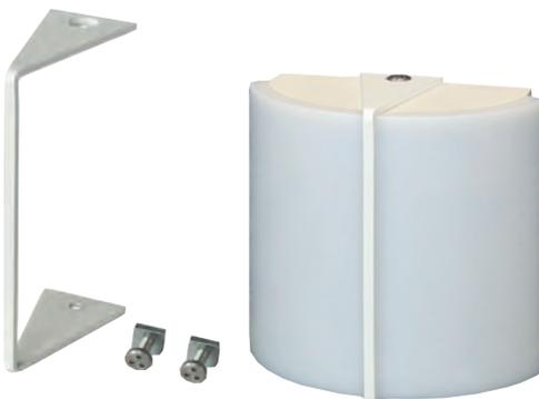
Metallbügel aus Stahlblech zur Sicherung der Gehäuseabdeckung der Zellsignalleuchte gegen unbefugtes Öffnen, mit zwei Dreilochschrauben und zwei in das dafür vorbereitete Gehäuse passende Muttern.
