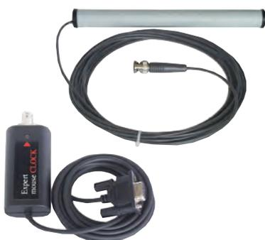
Ausstattungs paket Uhrzeit für Bildschirmabfragen zum Empfang des Langwellen-Zeitzeichensenders DCF77, bestehend aus einer entfernt montierbaren Empfangsvorrichtung zum Anschluß an die Bildschirmabfrage und einem Softwareprogramm zur systemmäßigen Aufbereitung zur Ansteuerung von Displays über den Zentralleitungszug und zur exakten zeitlichen Protokollierung von Alarmen und anderen Vorgängen.
