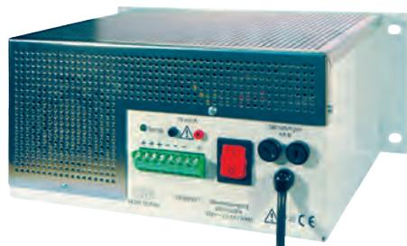
Netzgerät zur stationsweisen Spannungsversorgung, vorbereitet für Wandmontage oder waagerechte Aufstellung, geeignet für besonders hohe Einschaltströme, Ausführung gemäß EN60601-1, 2 MOPP, Schutzklasse I, IP20, spannungstabilisiert und kurzschlußfest, lüfterlos, Lieferung einschließlich Netzanschlußkabel.
