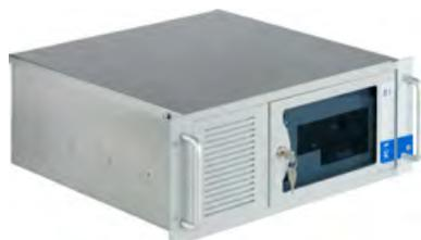
Bildschirmabfrage im 19"-Gehäuse mit allen systemmäßig benötigten Komponenten und einem vorinstalliertem aktuellem Windows - Betriebssystem. Der Lieferumfang beinhaltet Tastatur mit Schublade (2HE), Computermaus und Anschlußkabel (3m).
