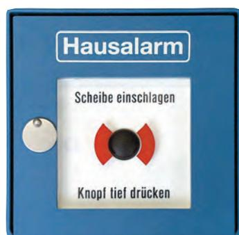
Druck- bzw. Springknopfmelder zur manuellen Auslösung eines Beamtalarms, Aufputzmontage im Innenbereich, Material Aluminium-Druckguß oder Kunststoff, blau mit Aufschrift "Alarm" o.ä., Deckel mit Scharnieren und mit Schlüssel verschließbar, Arbeitskontakt mit Abschlußwiderständen.
