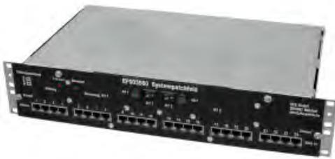
Systemspezifisches Patchfeld zur Bereitstellung aller normgemäß notwendigen elektrischen Sicherheitseigenschaften für die Terminals der Rufanlage, so dass handelsübliche IT-Infrastrukturgeräte (Switches etc., jedoch **nicht** PoE-Switches) verwendet werden können, die nicht die Anforderungen an die sichere elektrische Trennung gemäß DIN EN 60601-1 erfüllen.
