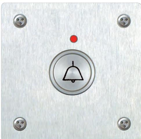
Ruftaster zum Auslösen eines Rufes, geeignet für robusten und gegen Vandalismus geschützten Betrieb nach IP54 für Feuchträume, mit Deckplatte aus V2A-Stahlblech (2 mm) und einem auf Druck reagierenden Piezo-Bedienelement mit integrierter Leuchtdiode zur Rufanzeige und als Findelicht. Die Befestigung in einer Aluminium-Unterputzdose mit Kabeleinführung erfolgt mittels vier Sicherheitsschrauben. Das Gerät eignet sich zum ruhestromüberwachten Anschluß an alle Rufeingänge eines Zellenterminals.
