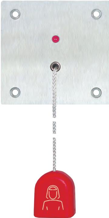
Zugtaster mit Zugschnur und Zugglocke für den Ruf nach dem Pflegepersonal, mit Deckplatte aus V2A-Stahlblech (2 mm) für robusten Betrieb. Die Befestigung in einer Aluminium-Unterputzdose erfolgt mittels vier Sicherheitschrauben. Das Gerät eignet sich zum ruhestromüberwachten Anschluß an alle Rufeingänge eines Zellenterminals.
