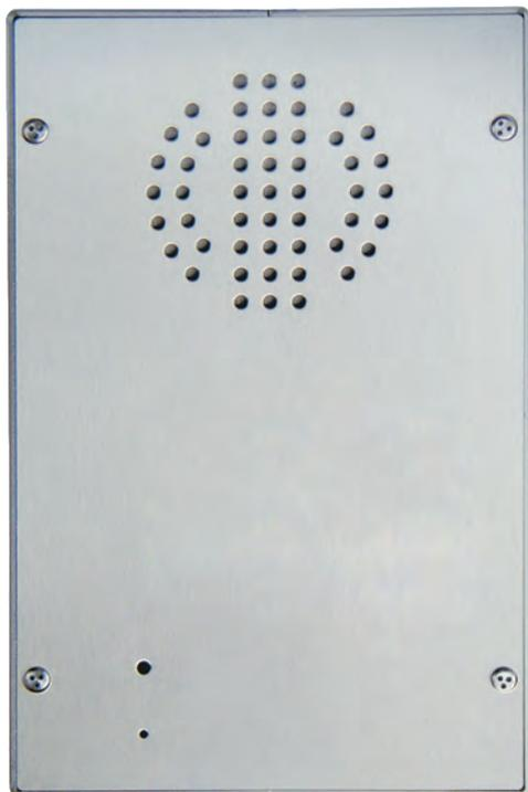
Durchsageterminal zur Ansteuerung von Leistungsverstärkern für externe Lautsprecher zur Weitergabe von allgemeinen oder gezielten Durchsagen in Flure oder Höfe in Unterputzausführung für robusten Betrieb, Frontplatte aus V2A-Stahlblech (2mm). Die Befestigung in einem Stahlblecheinbaukasten erfolgt mittels vier Sicherheitsschrauben.
