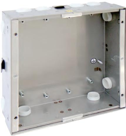
Stahlblecheinbaukasten für die Zellenterminal der Baureihe ZE1, gefertigt in Unterputz-Ausführung aus V2A-Stahl und breitem Stahlrahmen für wandbündigen Einbau und vorbereiteter Aufnahme für Kabeldurchlässe auf allen Seiten, Anschluß für Schutzerde, Putzdeckel. Der Kasten wird nach dem Einbau mit dem Montagesatz MS-ZLT (JV004007) ausgerüstet und ist vorbereitet zur Aufnahme des Zellenverteilers VZE1 (JV004210).
