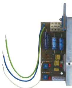
Leistungsverstärker 2x10 W zur Ansteuerung von Lautsprechergruppen mit einer Impedanz von 4 und 8 Ohm, geeignet zur Montage im Putzkasten ZEK einer Durchsageelektronik und zum Anschluß an den Zellenverteiler VZET, mit Anschlußklemmen und Mikroschalter zur Sabotagesicherung
