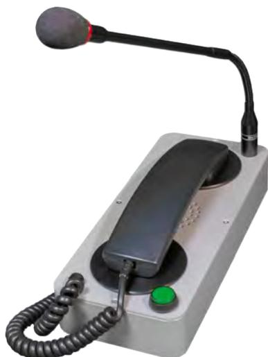
Sprechkombination als Tischsprechstelle für Bildschirmafragen zum Anschluß an Stationszentralen, mit Handhörer und integrierter Sprachwendetaste, Schwanenhalsmikrofon, Lautsprecher und Auswahl-taste Gegensprechen/Wechselsprechen, montiert in einem Aluminiumgehäuse. RJ45-Kabel (Länge 3m) zum Anschluß an eine UAE-Anschlußdose.
